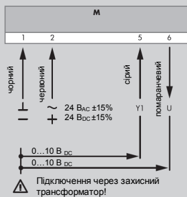
Схема підключення додаткових контактів NESM...-15S
