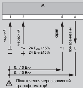
Схема підключення додаткових контактів NESM...-10S
