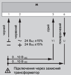
Схема підключення додаткових контактів NESM...-03S
